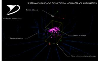
**SISTEMA EMBARCADO DE MEDICIÓN VOLUMÉTRICA AUTOMÁTICA**
